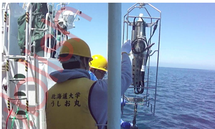
Gambar 4.12. Instrumen Conductivity Temperature Depth (CTD). Gambar Diambil Dalam Survei Lapangan dengan Menggunakan Kapal Latih "Ushio Maru" Hokkaido University Tahun 2012.
